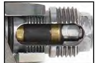
El diseño de aguja totalmente encerrado elimina la exposición a los fluidos y prolonga la vida de la aguja.
