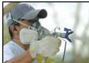
Gatillo de pistola para 4 dedos FTx: el gatillo completo es más fácil de sostener cuando se atomiza de manera continua.
